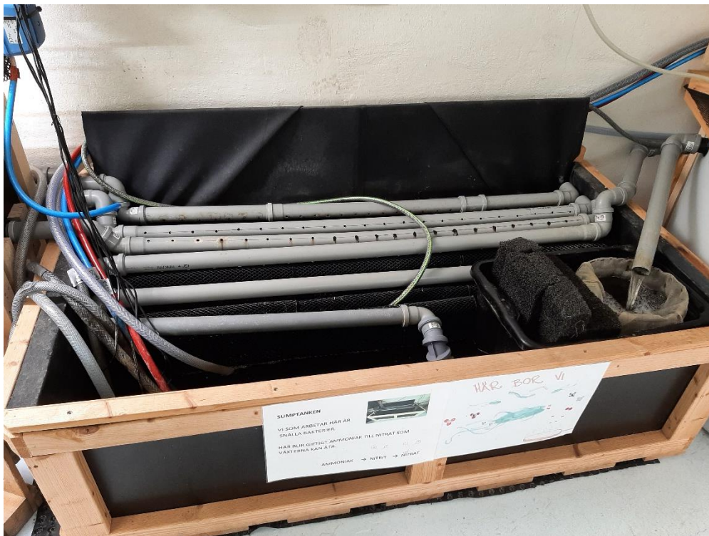
Attēls 7. Biofiltrs akvaponikas sistēmai Roslagenas Universitātes studentu pilsētiņā, Norteljē.
