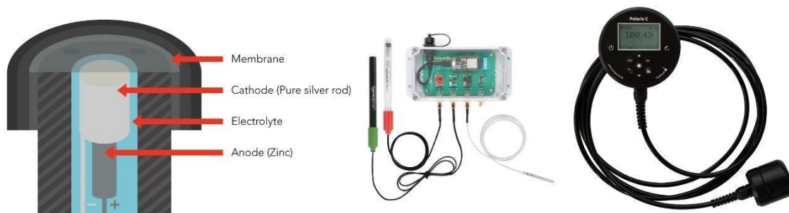
Joonis 3. Atlas Scientific jälgimissüsteem ja Handy Oxyguard O 2 sensor.
