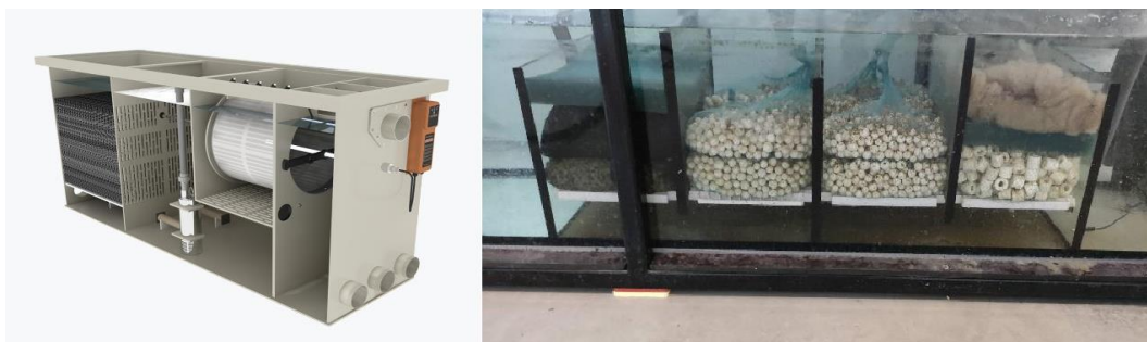
Joonis 14. Mehaanilised filtrid ja biofiltrid sette mehaaniliseks eemaldamiseks kalabasseinist.
