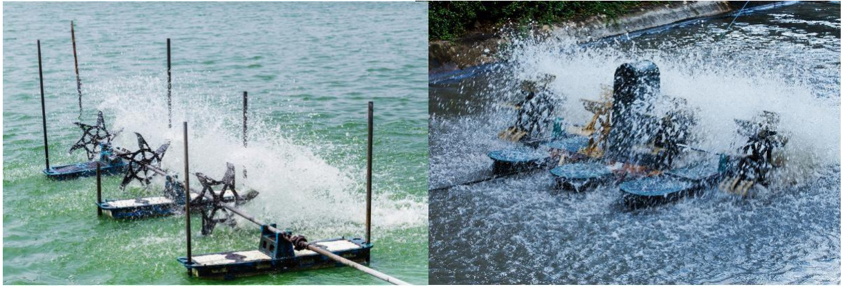
Joonis 20. Labaeraatorid suuremahulistes vesiviljelussüsteemides
