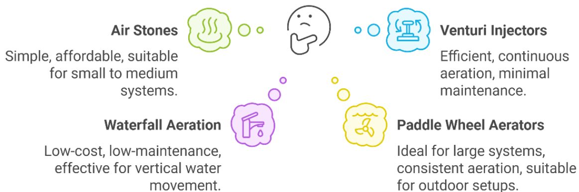
Kuvio 17. Yhteenveto kalanviljelyssä yleisesti käytetyistä veden ilmastustekniikoista.
