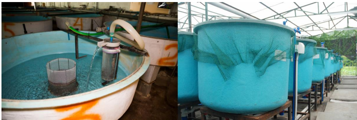
Kuvio 9. Lasikuituiset kalankasvatusaltaat akvaponisessa vesiviljelyjärjestelmässä.
