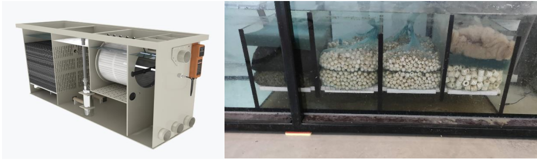
Kuvio 14. mekaaniset suodattimet ja biosuodattimet lietteen mekaaniseen poistoon kala-altaista.
