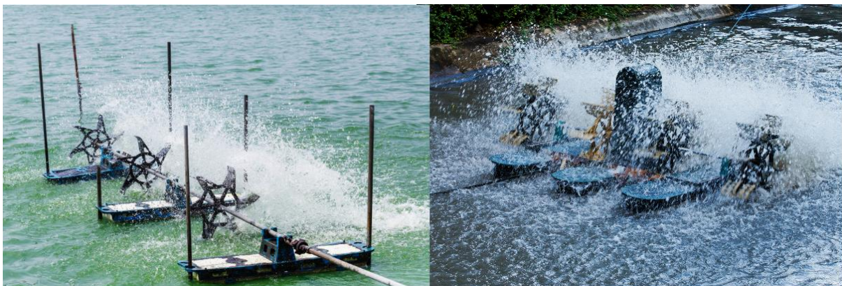
Kuvio 20. Siipirasilmastuslaitteet suurissa vesiviljely-yksiköissä.
