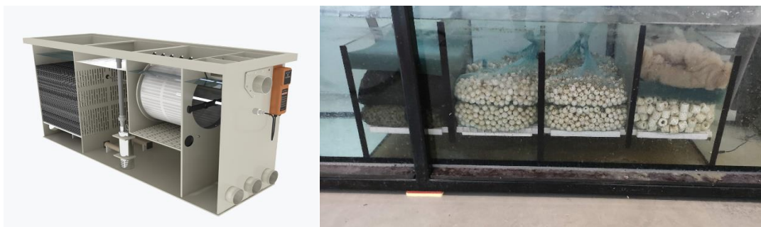
Figur 14. Mekaniska filter och biofilter för mekanisk avlägsning av slam från fiskbassängen.
