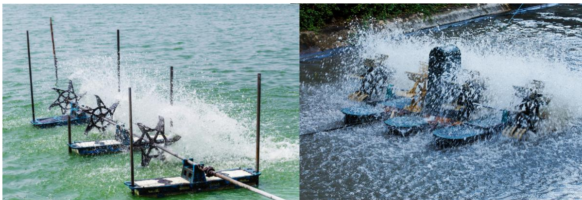
Figur 20. Paddelhjuls-luftsanordningar i storskaliga akvakultur-enheter.
