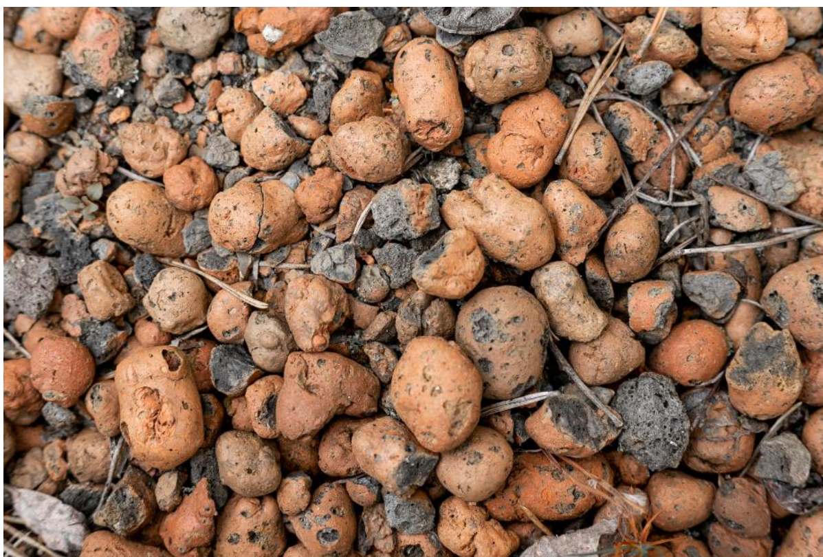
Fig. 8. Expanderad lera används i medie bäddar för akvaponik.
