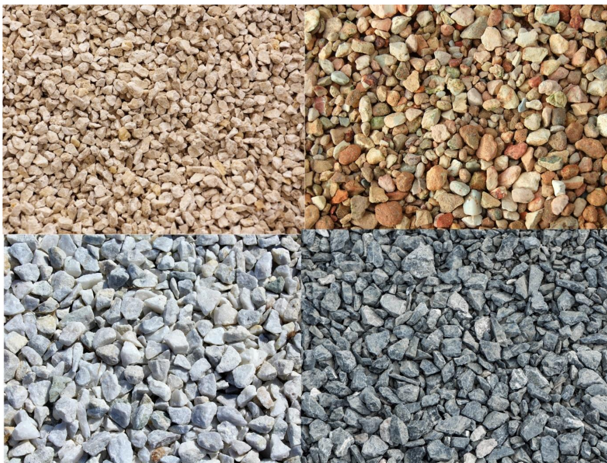
Fig. 21. Olika typer av grus används i mediebäddar för akvaponik.
