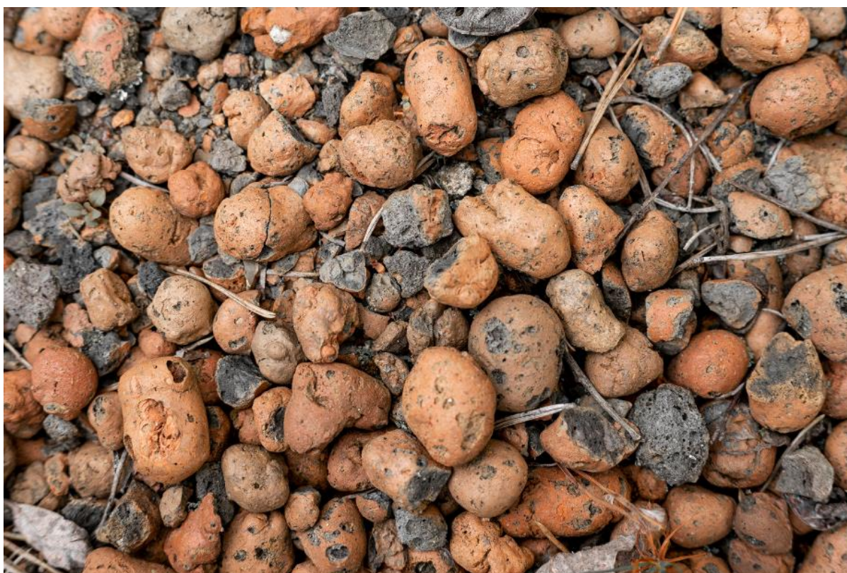
20. attēls. Keramzīts, ko izmanto akvaponikas sistēmās.
