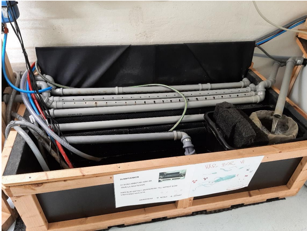
Joonis 5. Biofilter akvapoonikasüsteemi jaoks Roslageni ülikoolilinnakus, Nortaljes.
